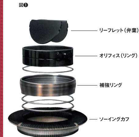
[図1] 機械弁の構造
